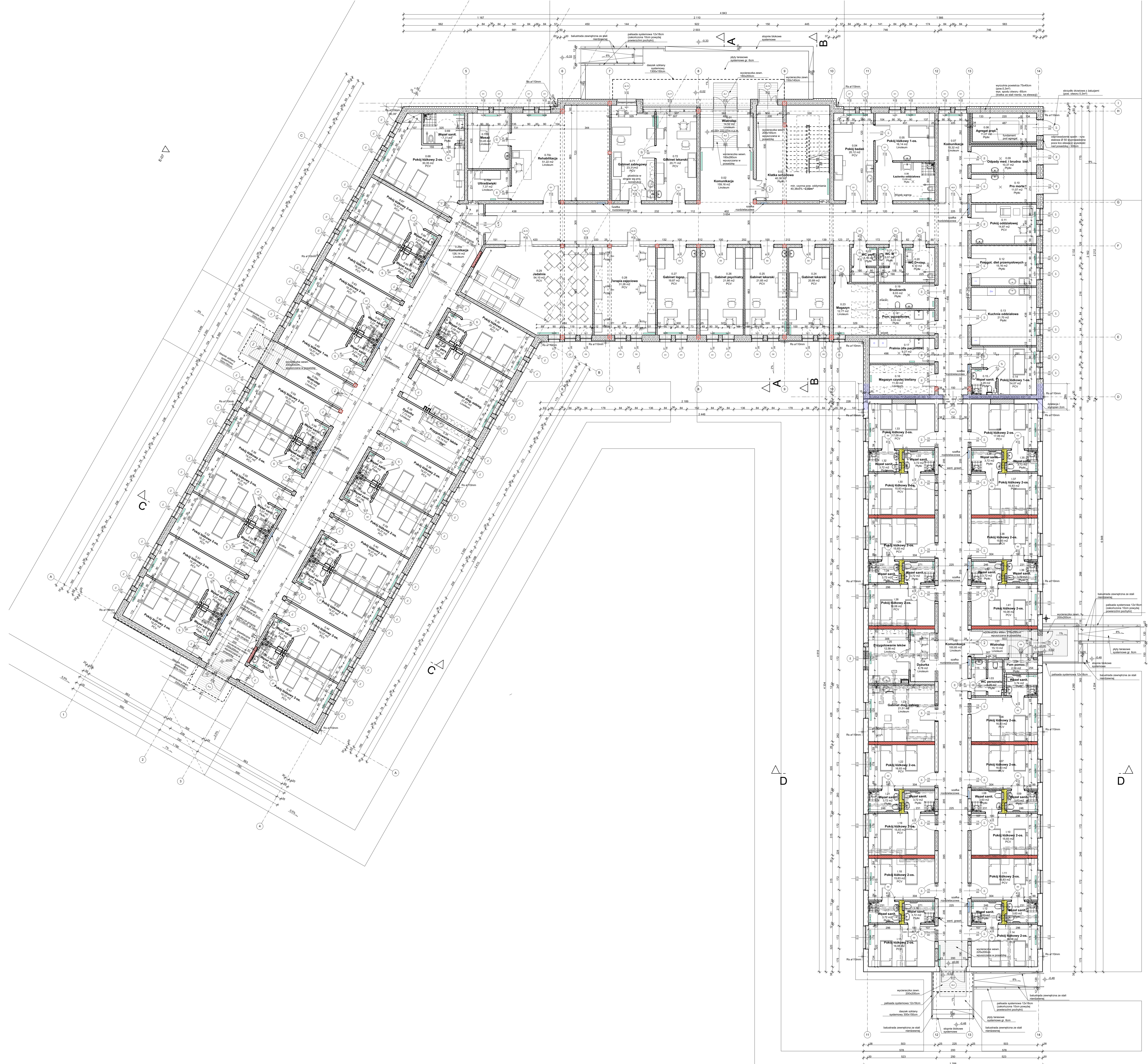
schemat kominów wentylacyjnych murych w bud. istniejącym skala 1:50
